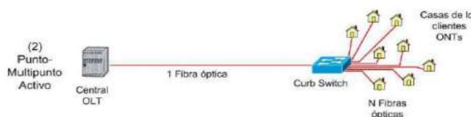
Imagen 4 Tipo de conexión GPON
