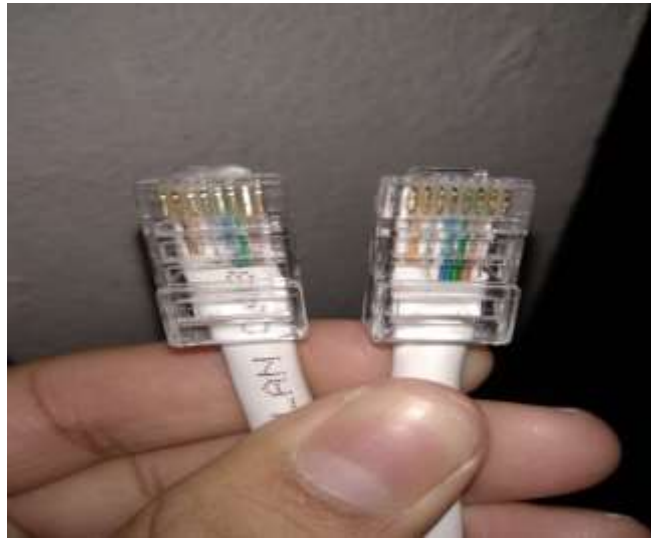
Imagen 90 Ponchado de cable tipo B
