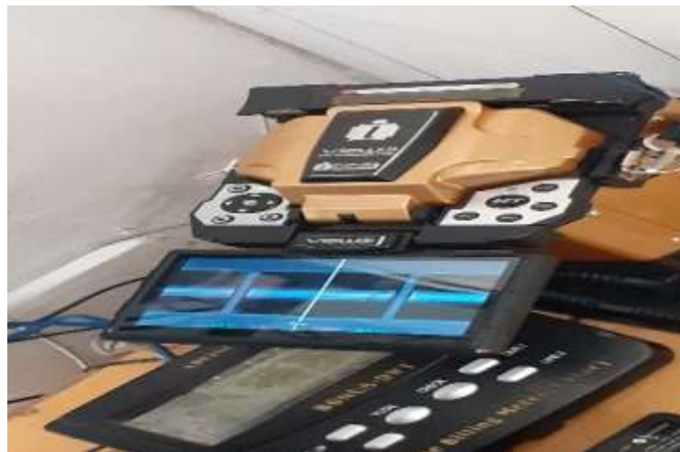
Imagen 77 Verificación del estado de fusión
