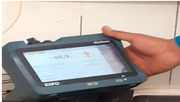
Imagen 84 Comprobación de la atenuación
