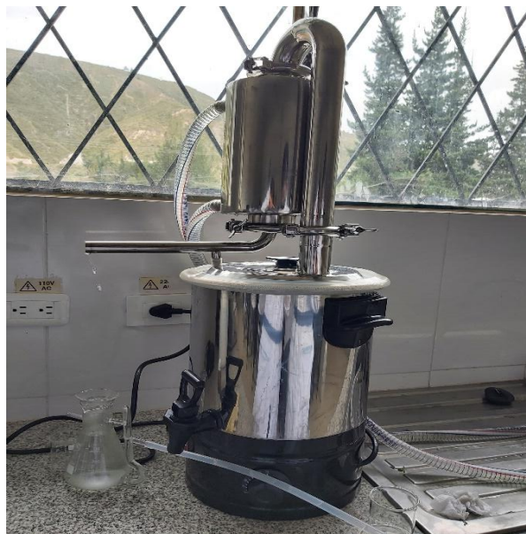
Figura 24. Equipo “XIAOJIAN” (Lanphan Ltd., China) destilador de arrastre de vapor de aceites esenciales
