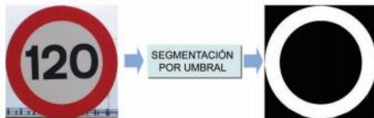
Figura 13. Segmentación basada en umbral de intensidad de gris
