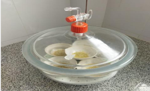
FOTOGRAFIA 13. Medición de humedad.
