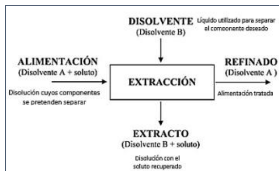
Figura 13. Esquema idealizado de una extracción liquido-liquido.
