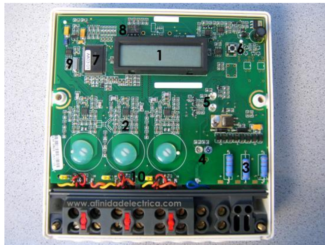
FIGURA 1.6: CIRCUITOS INTERNOS DE UN MEDIDOR ELECTRÓNICO
