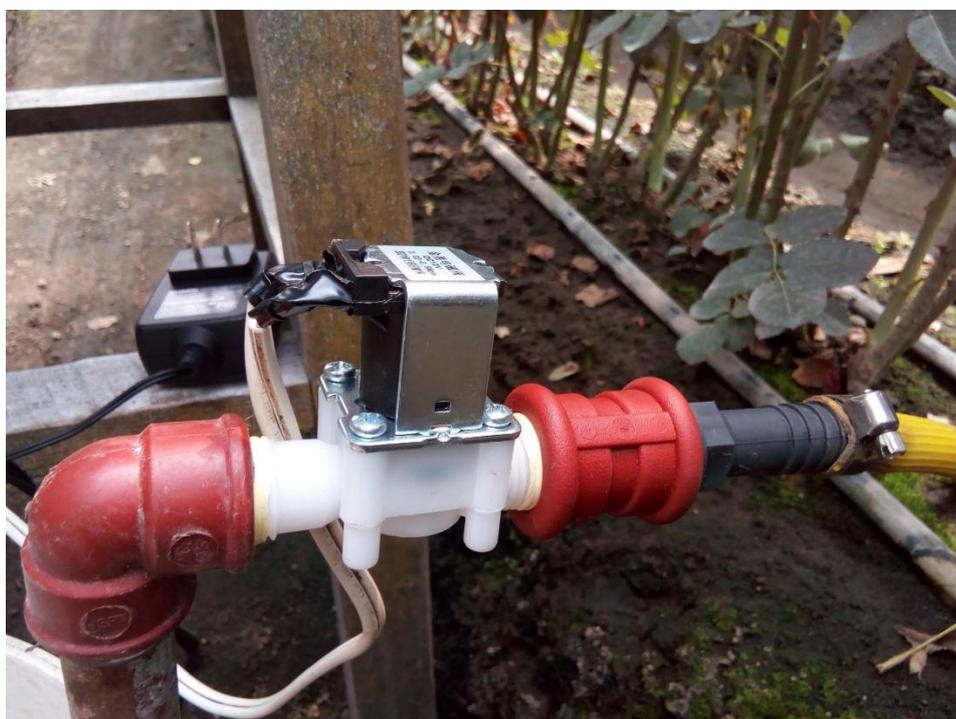
**Figura H.2.** Electroválvula del prototipo.
