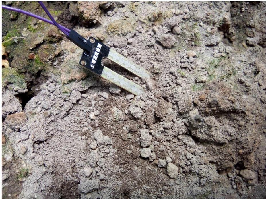
**Figura H.4.** Sensor FC-28 del prototipo.
