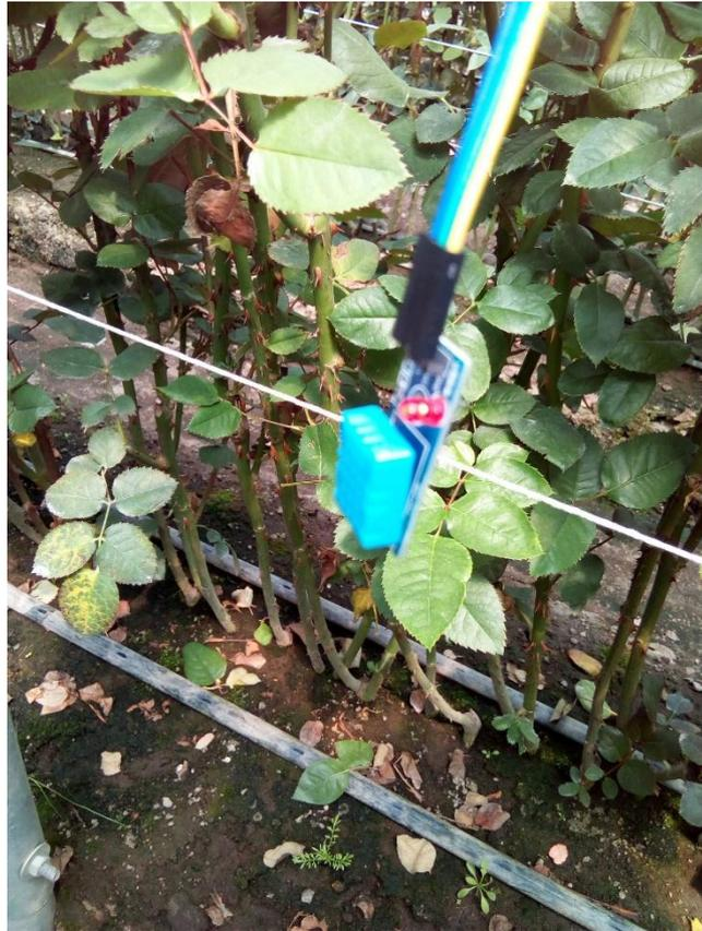
**Figura H.3.** Sensor DHT11 del prototipo.
