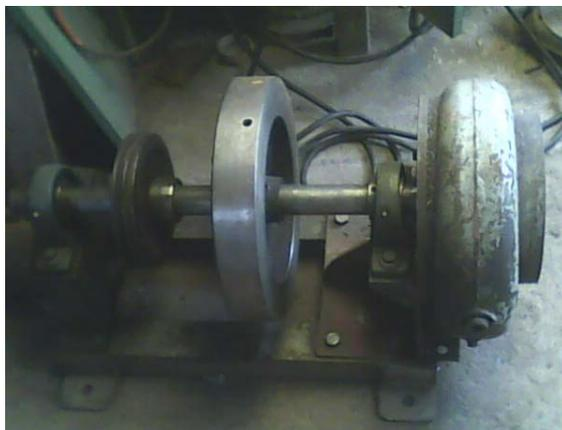
Vista posterior de la turbina, eje, contrapeso
