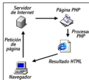
Figura 5: Esquema de funcionamiento de PHP.
