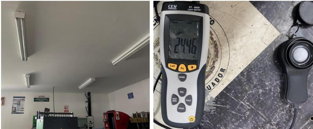
Figura 30 Medición luxómetro aula
