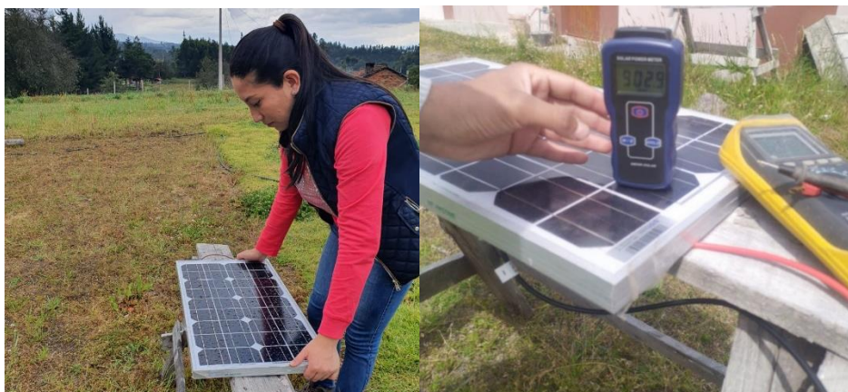
Figura 13. (a) Panel fotovoltaico monocromático (b) Medición de la radiación solar, voltaje generado y corriente.
