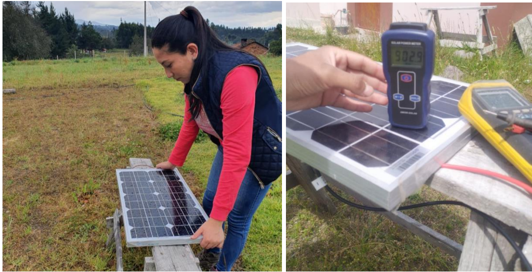
(a) Mediciones del potencial generado de un panel monocristalino.
