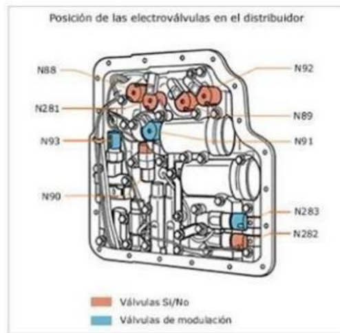
Figura 1.21 Posición de la electroválvula en el distribuidor Fuente: [28]
