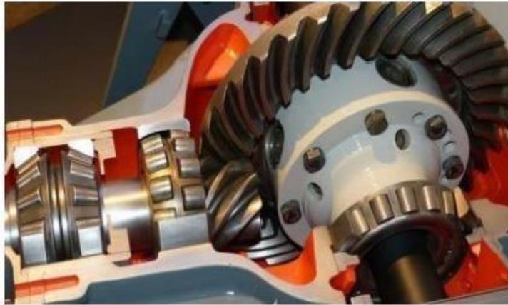
Figura 1.2 Lubricación de aceite en los piñones
