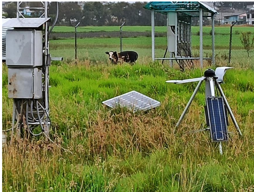
Figura. 5 Estación meteorológica automática de IZOBAMBA (INAMHI)
