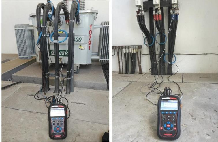
Medición de corriente con analizador de redes
