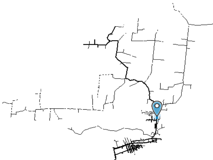
Figura 18. Topología del alimentador No. 03 S/E La Maná_ELEPCO
