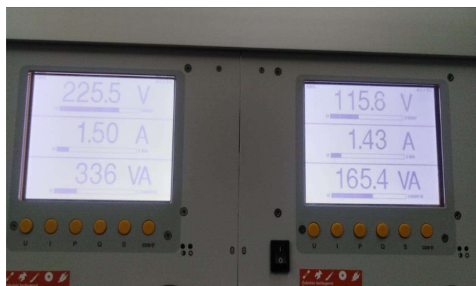
Figura. 71 Resultados de datos medidos en entrada y salida del convertidor.
