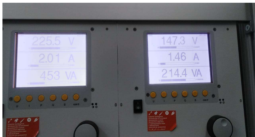
Figura. 73 Resultados de datos medidos en entada y salida del convertidor caso 2.
