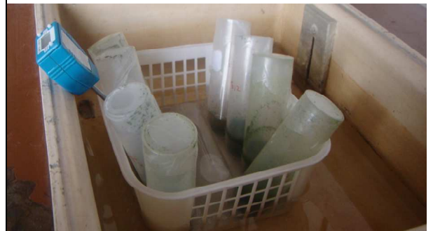
Fotografía N°26. Filtración de los tratamientos para la determinación del Índice de solubilidad y absorción de agua
