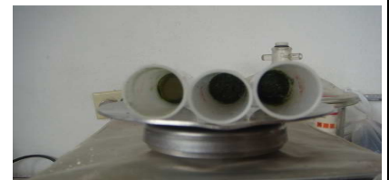
Fotografía N°26. Filtración de los tratamientos para la determinación del Índice de solubilidad y absorción de agua
