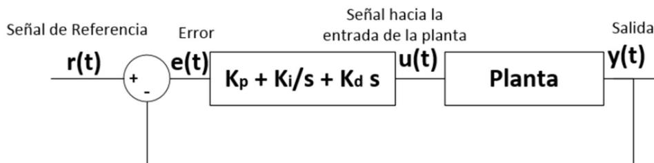
**Figura 46.** Sistema de control PID. Fuente:[44]
