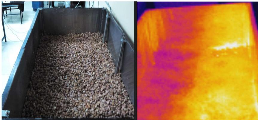
**Figura 69.** Distribución de temperatura en la secadora.
