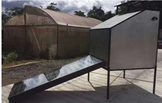
**Figura 19:** Secado con ayuda de energía solar **Fuente:**[16]
