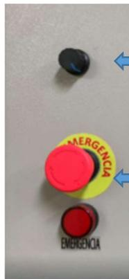
Potenciómetro para ajustar el set point del proceso; 2.2 v representa el set point 60 °C
