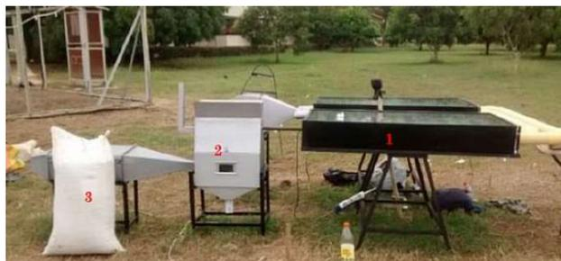
**Figura 20:** Secador híbrido compuesto de los (1) colectores solares (2) Quemador de biomasa (3) Secador **Fuente:**[17]
