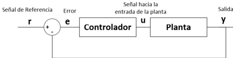
**Figura 45.** Sistema de control en lazo cerrado. **Fuente:**[44]
