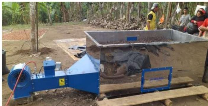
**Figura 24:** Secador rectangular **Fuente:** [21]
