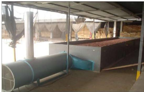
**Figura 18:** Secador GLP Fuente:[15]
