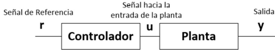
**Figura 44.** Sistema de control en lazo abierto. **Fuente:**[44]
