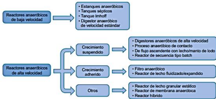
Figura 1.5 : Clasificación de los reactores anaeróbicos.
