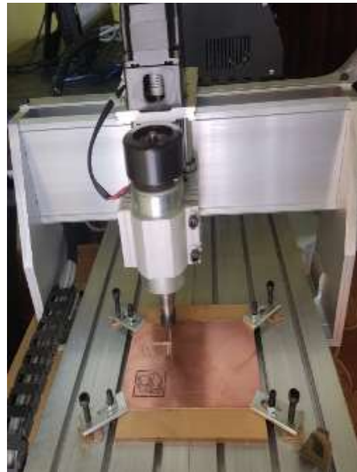
Fotografía 4: Trazado de pistas de PCB
