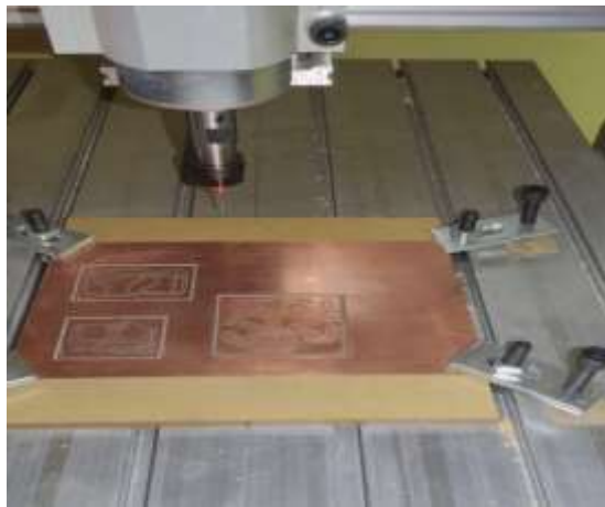
Figura 29. Elaboración de placas PCB
