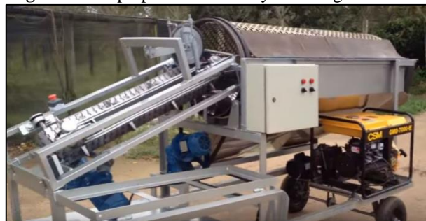
Figura 9: Despulpadora de corte y centrifugado
