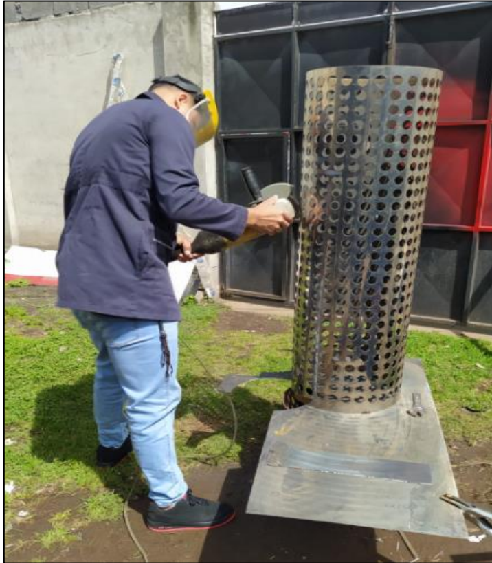
Figura 43: Armado del despulpador
