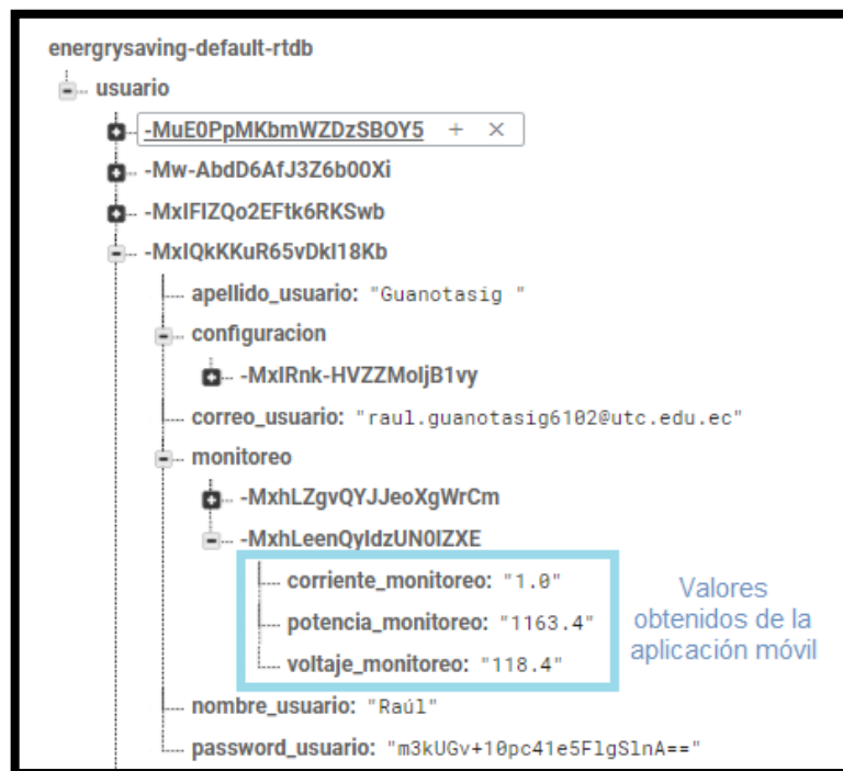
Figura 5.27. Almacenamiento de datos en tiempo real en la base de datos de Firebase
