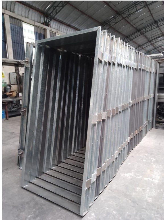
Fotografía 3: Armado de puertas
