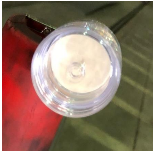
Figura 4.5. Filtros de membrana en porta filtros
