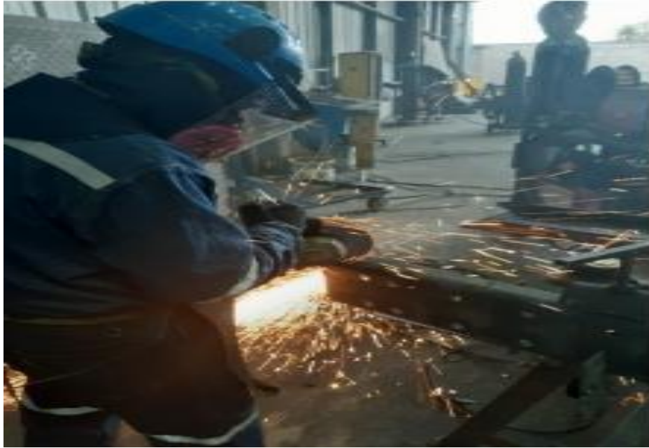
Monitoreo de vibración mano brazo – P5: Amoladora disco línea de armado 3
