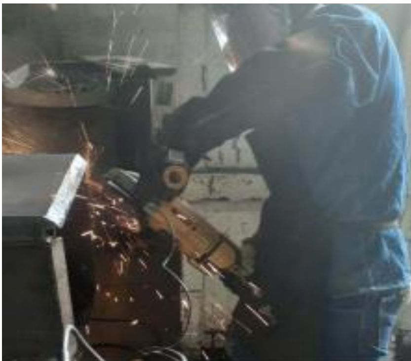
Monitoreo de vibración mano brazo – P4: Amoladora disco desbaste – Línea de armado Nro 5
