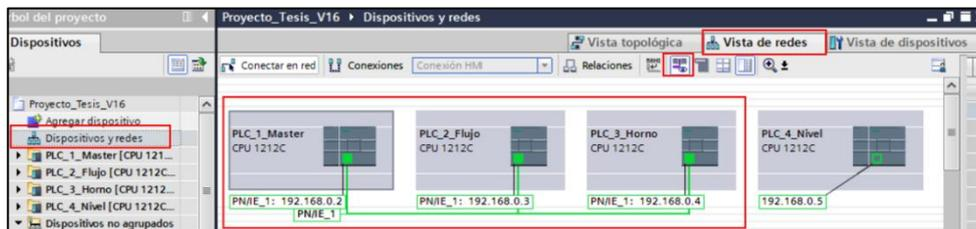
Figura 4.14. Red de comunicación Ethernet entre los 3 autómatas.
