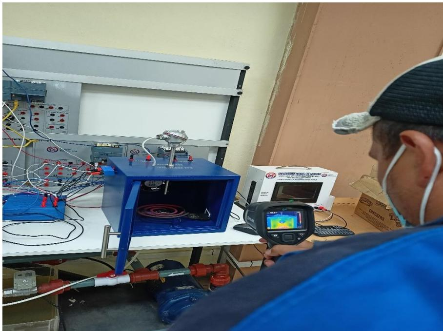
Anexo L.3. Medición de la temperatura en el interior del horno con la cámara termográfica
