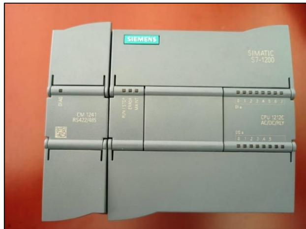
*Figura 4.7. PLC-1200 con el módulo CM 1241 RS422/485, fuente Autores.*
