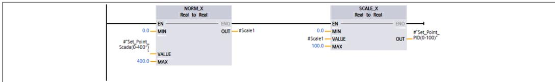
Anexo C.7. Programación Ladder en el bloque de función FB3 para normalizar y escalar el Set Point para ingresar en el bloque PID estandarizado de 0 a 100%.
