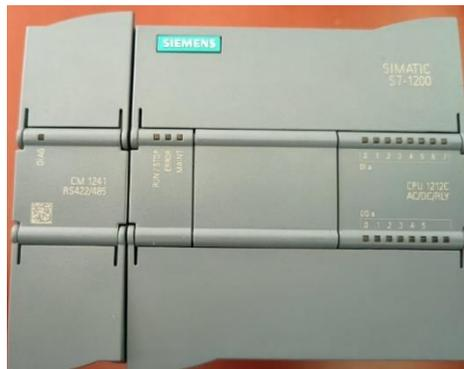
Agregar los autómatas S7-1200 y los módulos CM1241 RS422/485 (6ES7 241-1CH32-0XB0) en la estación del maestro y esclavo respectivamente.
