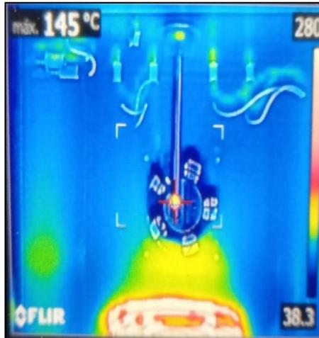
**Figura 5.9.** Variables del proceso de temperatura con la cámara termográfica en el sensor RTD PT-100.
