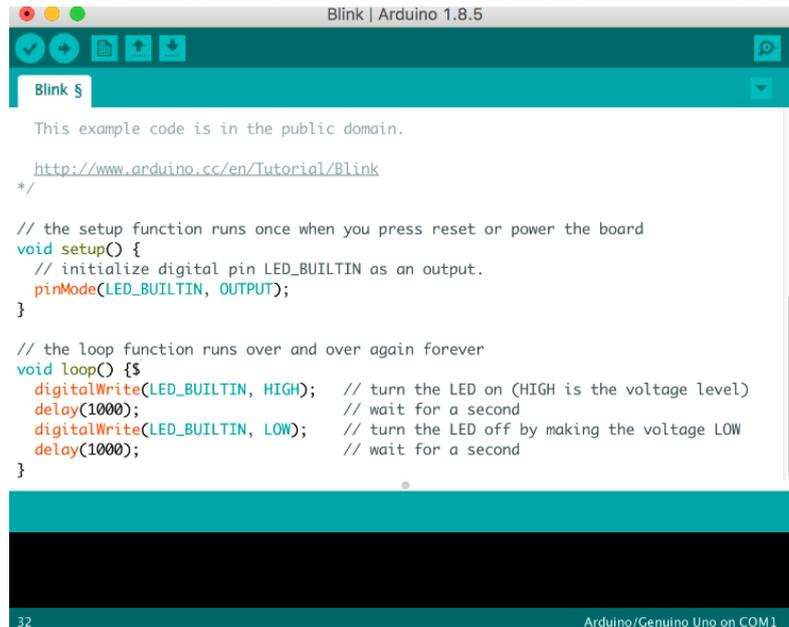
Figura 3.9. Arduino IDE y un programa de ejemplo [43]
