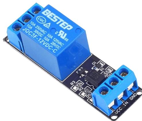
Figura 3.7. Módulo relé de 1 canal [41]
