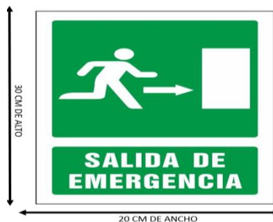
Figura 5.32. Señalización para identificar salidas de emergencia.
