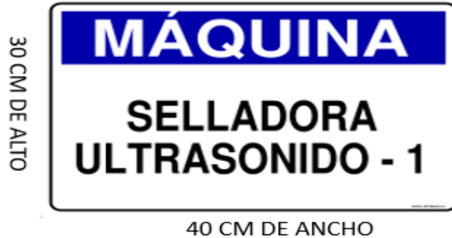
Figura 5.29. Señalización para identificar máquinas, equipos, puestos de trabajo.
