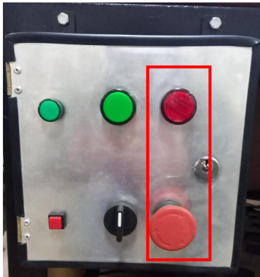
Figura 5.8. Señal de activación Paro de Emergencia.
