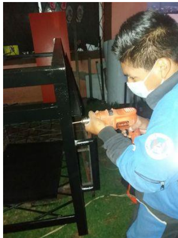
Figura 32. Perforación de agujeros para pernos en paredes laterales.
