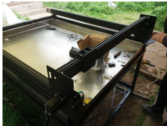
Figura 17. Colocación de placas en el eje y.
