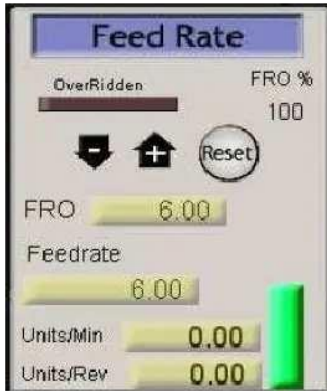
Figura 5. Sección de avance
