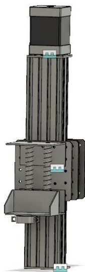
Figura 4.12. Sistema de guías y acoples para desplazamiento.
