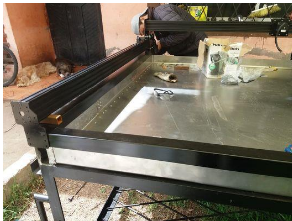
Figura 18. Fijación con tornillos M5 de las placas del eje y.
