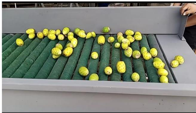
**Figura 5.13.** Sistema de limpieza entre la tuna y la fibra.
