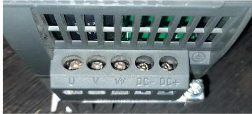
El variador de frecuencia debe ir conectado a un toma corriente de 220V, para que funcione adecuadamente. A continuación se muestra las entradas en donde deben ir los cables para la alimentación del variador.
