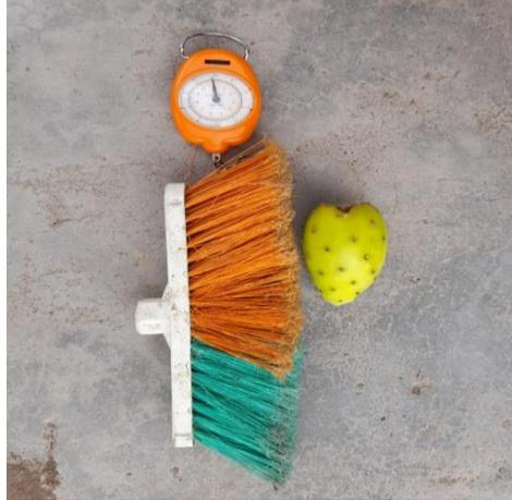
**Figura 5.10.** Fuerza de fricción entre la tuna y la escoba de nylon.
