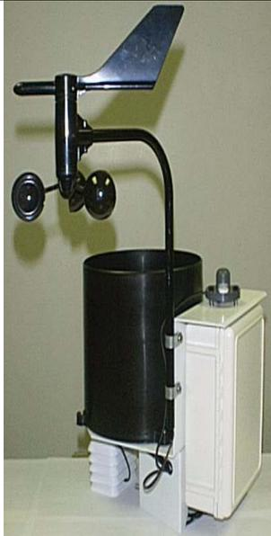
Excepto para el anemometro, la estacion viene completamente compuesto y listo para instalacion. La rama del anemometro esta sujetado al placa adetras con dos abrazaderas. Despues la rama esta en el sitio corecto, los tornillos este apretado la rama esta segura.
