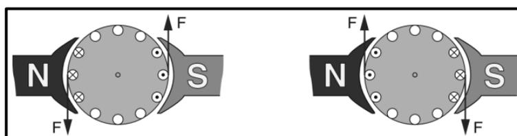
**Figura 1.16.** Inversión del sentido de giro de un motor con varias bobinas
