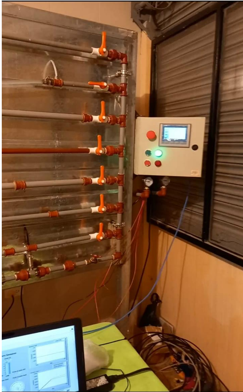
Figura E.9. Pruebas finales del sistema de supervisión y adquisición de datos.
