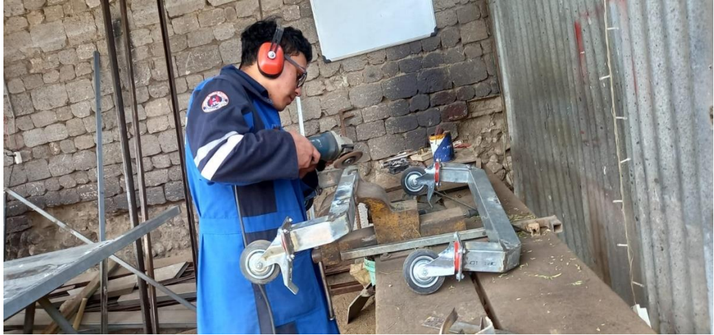
Figura E.2. Acople de ruedas en el soporte para tuberías.
