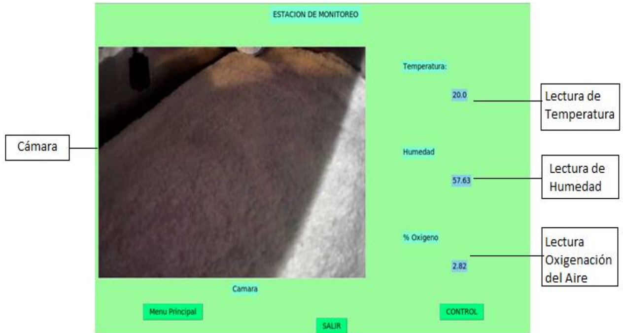
Figura 3.- Estación de Monitoreo
