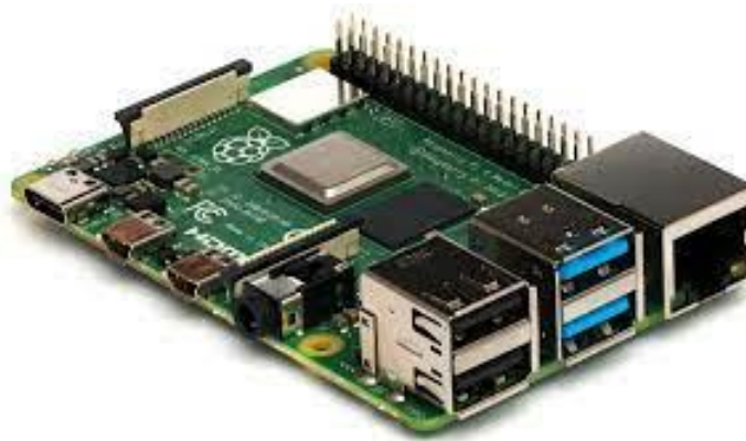
Figura 3.17.1 Esquema de los componentes que integran una Raspberry Pi 4 Modelo B [16].
