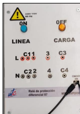
Fig. 3-8. Diseño de la parte delantera de la caja del Relé Diferencial.
