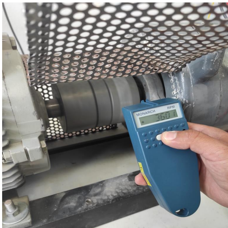
Figura B.6. Valor de los r.p.m de la Unidad motor generador AC-AC.
