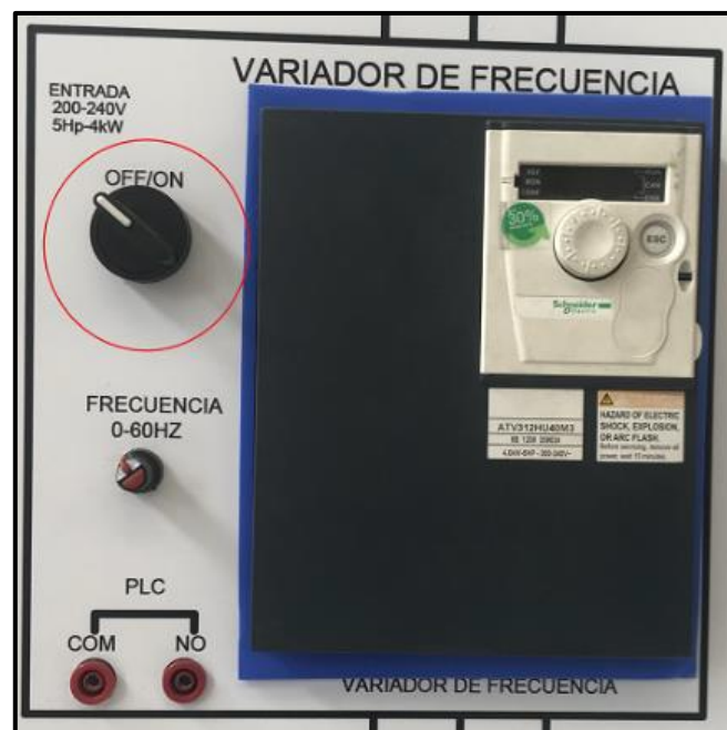
Figura 6. Selector del variador de frecuencia
