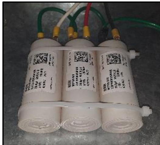
Figura 11. Capacitores de 20 uF
