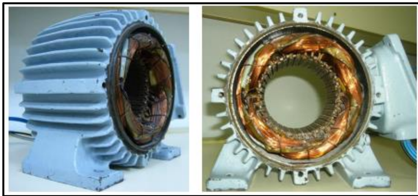
Figura 3.5. Estator y carcasa de la máquina asíncrona o de inducción [10].
