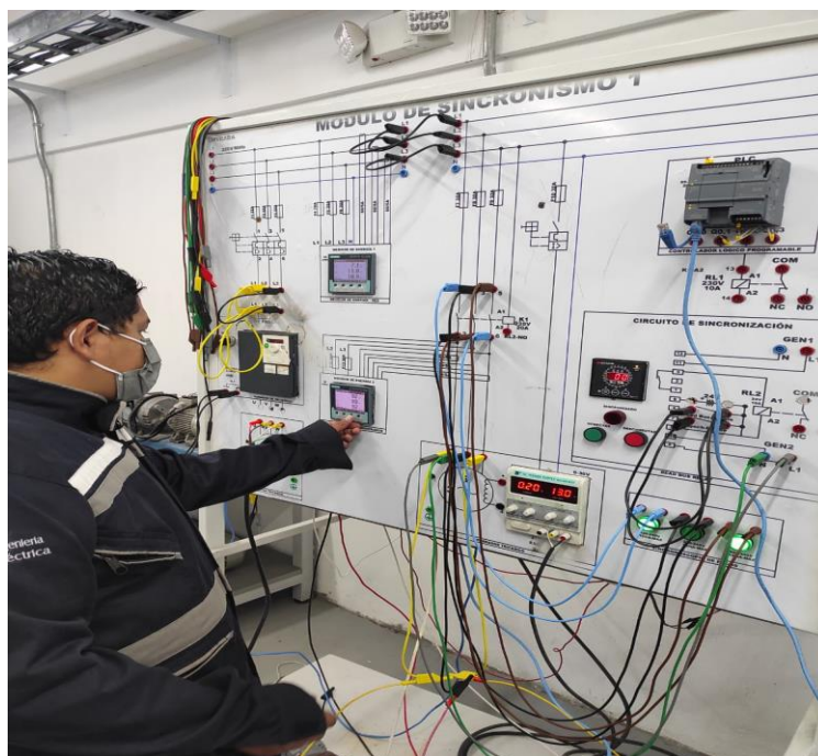
Figura B.5. Obtención de los voltajes con carga del generador.
