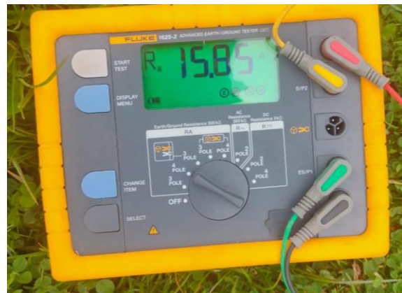
Figura 8.25. Colocando el telurómetro en la opción 4 pole y resultado de la medición.
