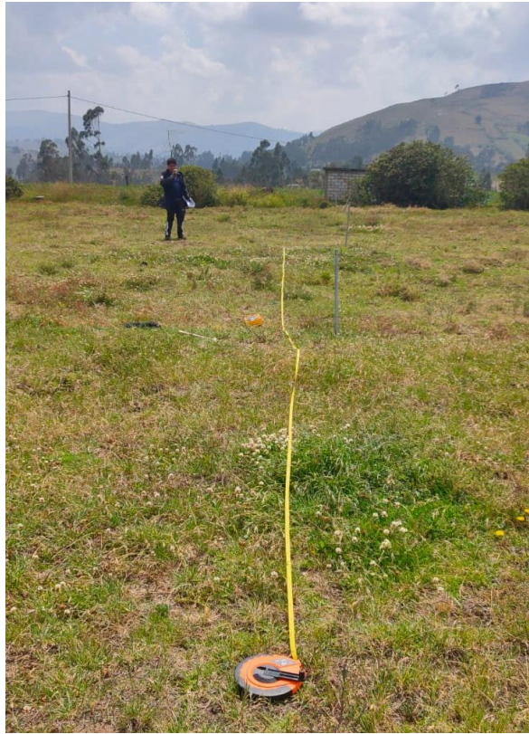
Figura 8.24. Medición del terreno y enterrado de electrodos (método de Wenner).
