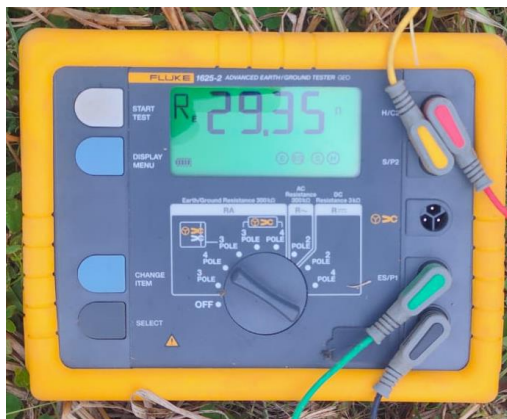
Figura 8.25. Colocando el telurómetro en la opción 4 pole y resultado de la medición.
