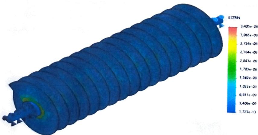
Figura 6. Análisis de deformaciones estático de la pieza
