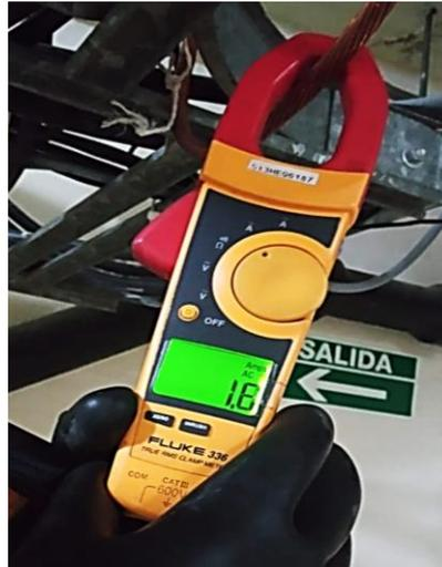
**Figura 4.7.** Pinza Amperimétrica Fluke 336
