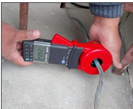
**Figura 4.9.** Medición con el Probador de resistencia AECM 3037
