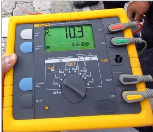
**Figura 4.10.** Telurómetro FLUKE 1625-2.
