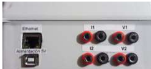
Figura VI.6. Instrumento de medición para corriente y voltaje
