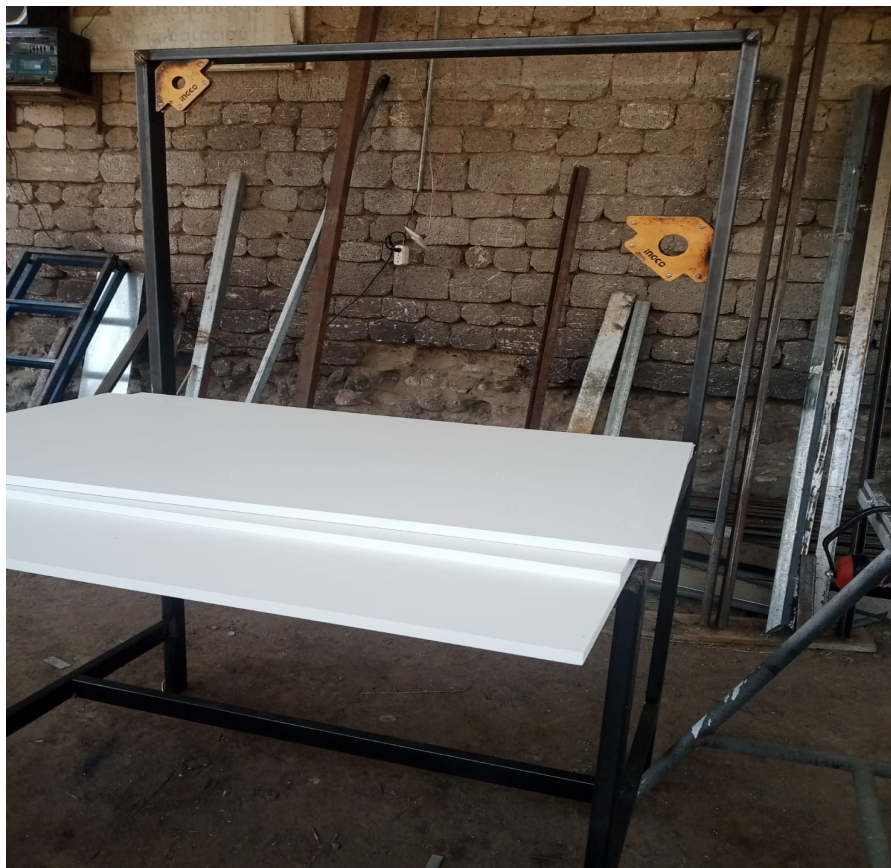
Figura E.1. Estructura de la mesa y colocación del MDF
