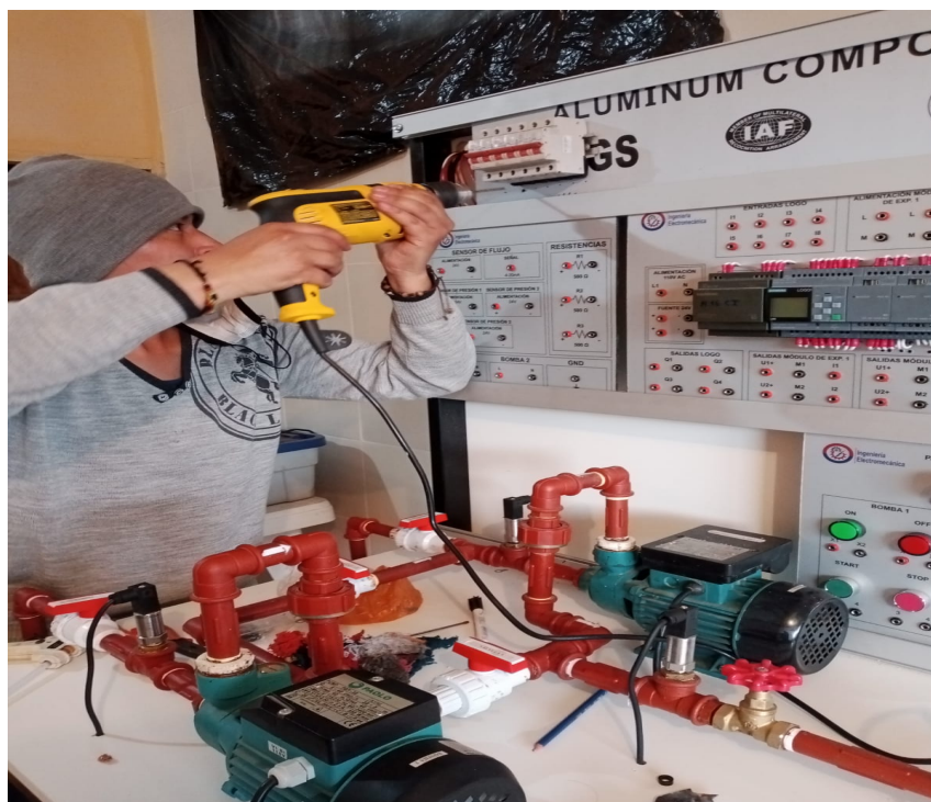
Figura E.6. Colocación de las placas de conexión en los perfiles de aluminio
