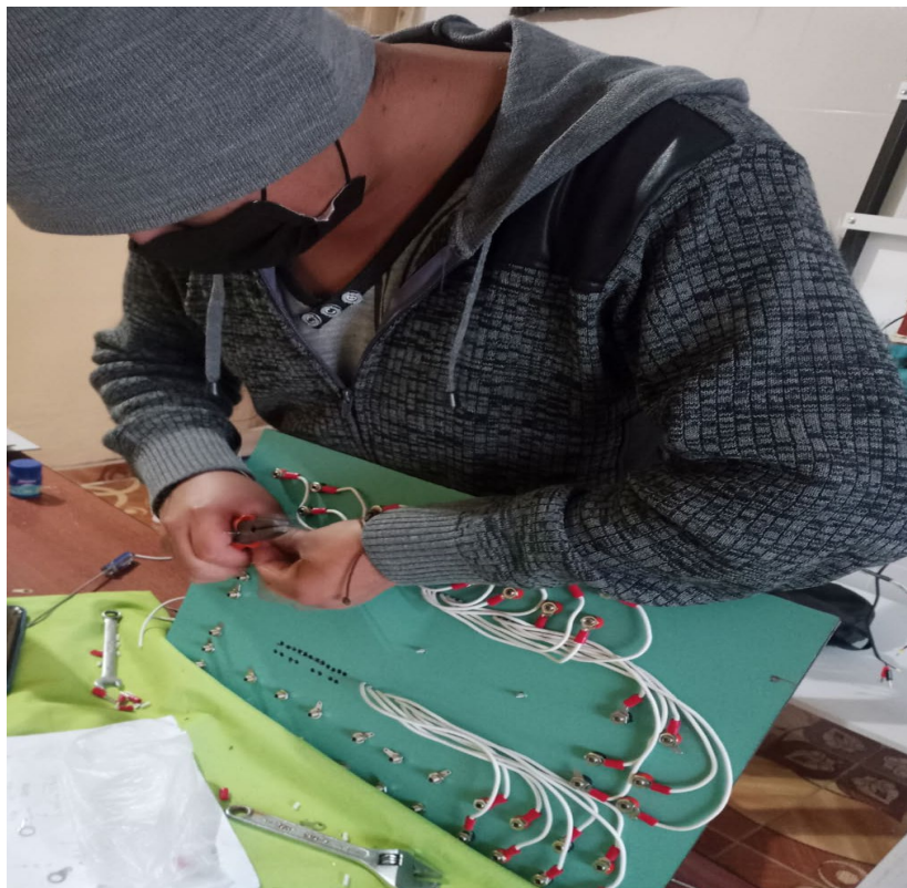
Figura E.5. Instalación de botones, plugs, logo, contactores y pantalla delta HMI en las placas de alucobond
