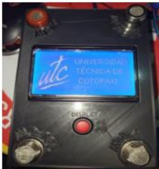
Figura 3.3. Dispositivo electrónico para la cuantificación de tipos de carbono [9].
