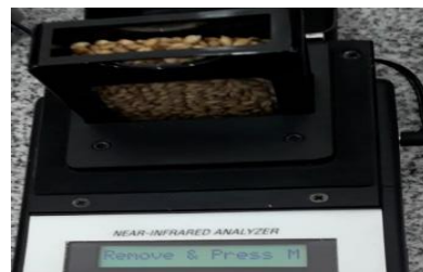
Fotografía 6 Oprimir la tecla measure hasta cuando aparecer la en la pantalla Remove & Press M .
