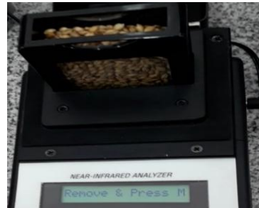
Fotografía 6 Oprimir la tecla measure hasta cuando nos aparezca la en la pantalla Remove & Press M .
