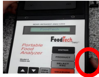
Fotografía 2 Conectar el Adaptador y prender el analizador del lado derecho del equipo.
