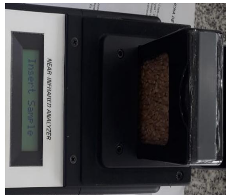
Fotografía 4 Colocar la muestra de calibración y oprimir la tecla MEASURE y esperamos hasta que nos aparezca Insert Sample.
