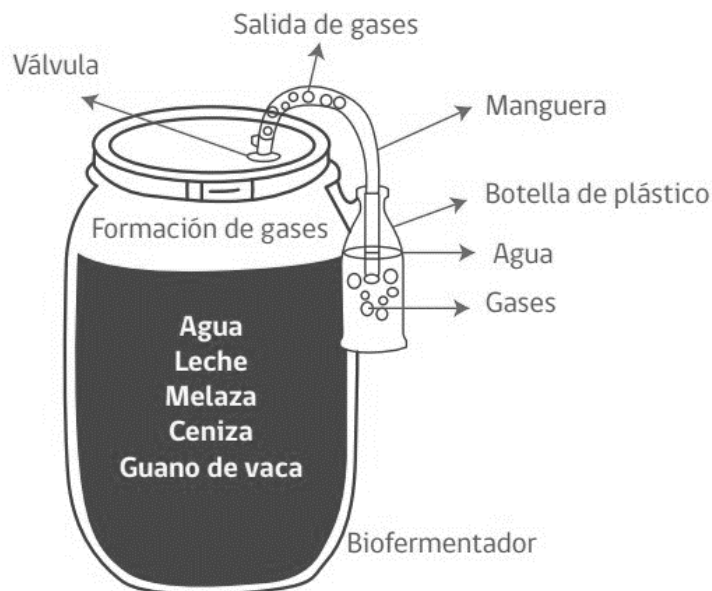
Gráfico 1. Componentes del biofermentador.
