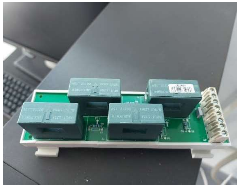
Fotografía C.10: Ensamblado de los TC's Fuente: Carrera de Electromecánica
