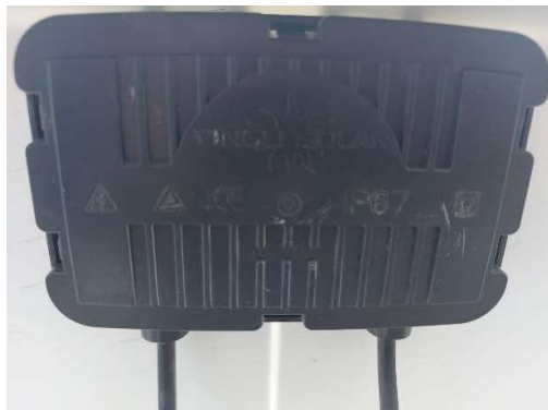
Fotografía C.5: Caja de In/Out de los paneles Fuente: Carrera de Electromecánica
