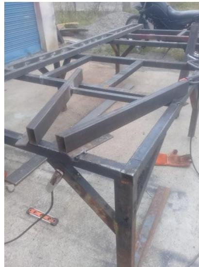
**Figura 8.** Ensamble de la máquina CNC de corte por plasma.
