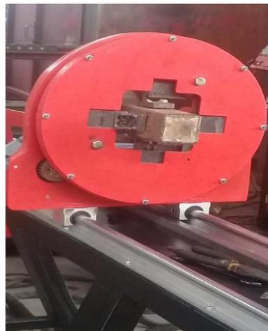
**Figura 4.10.** Riel con rodamientos lineales para el eje Y.
