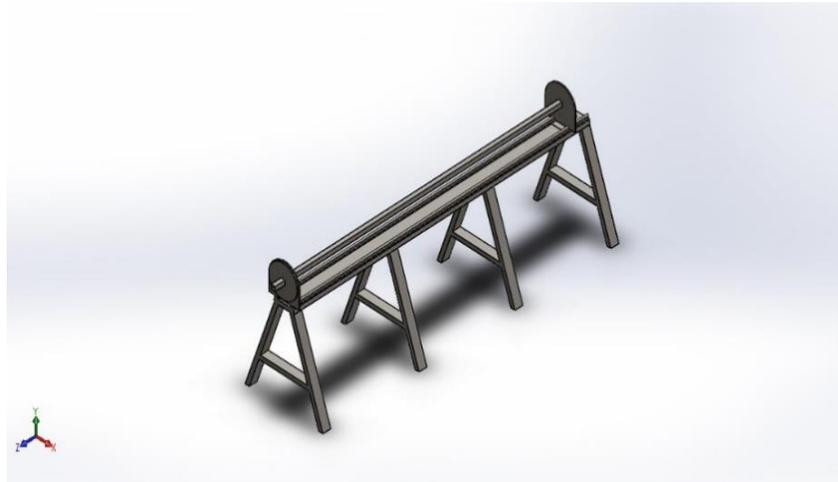
**Figura 4.13.** Modelo estructural cortadora de tubos CNC.
