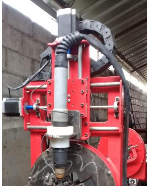
**Figura 4.11.** Riel de 6mm de radio con rodamiento lineales para el eje X y Z.
