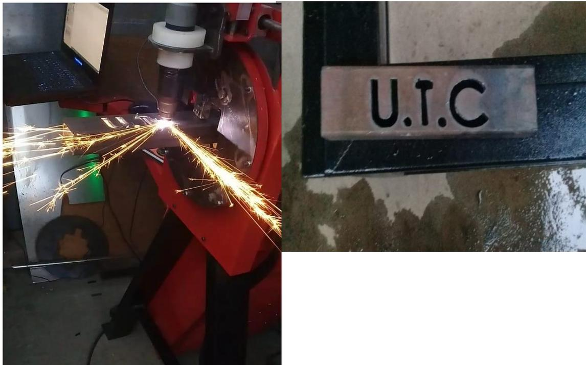
**Figura 5.9.** Resultado del corte de letras en el tubo rectangular de acero.
