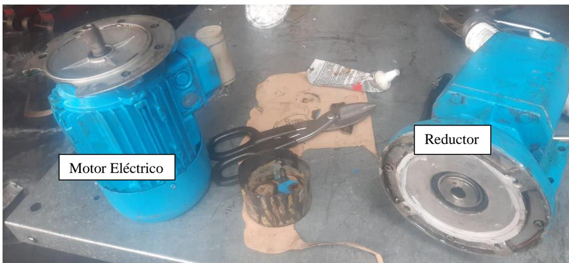
Ilustración 5 Partes del motoreductor lineal serie C
