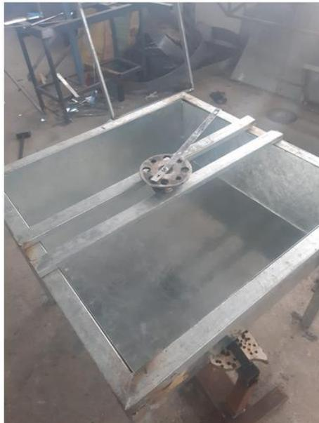
Ilustración 1 Tanque reservorio de acero galvanizado
