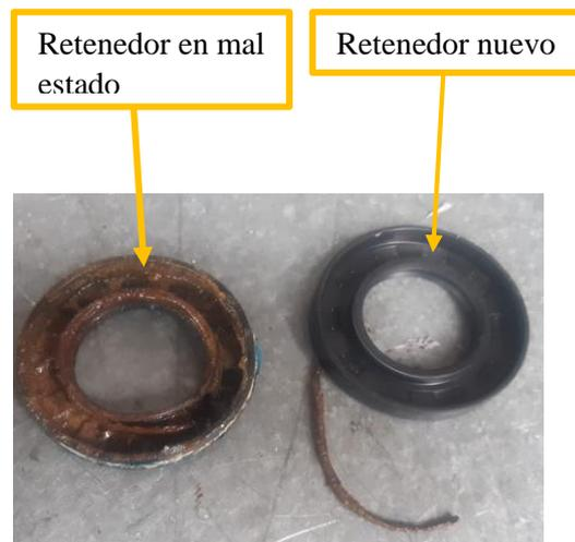
Ilustración 4 Retenedor con una posible fuga de aceite de reductor
