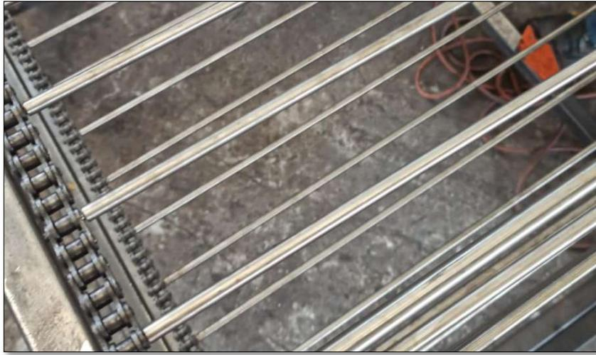
**Figura 4.15.** Eje acoplado a la cadena.
