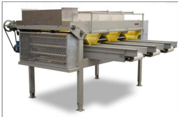
**Figura 3.5.** Clasificadora de frutos mediante una banda transportadora. [17]
