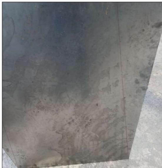
**Figura 4.9.** Planchas de acero ASTM A36 del recubrimiento lateral de la máquina.
