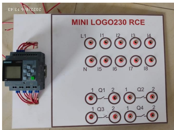
Imagen 13: Cableado del Mini Logo 230 RCE
