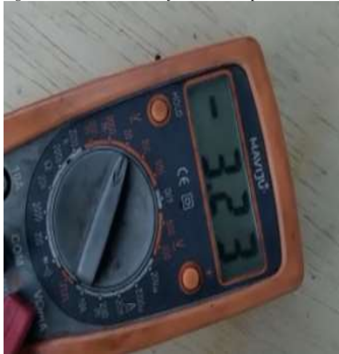
Figura 48. Medición del voltaje de salida al aplicar una fuerza con el pie
