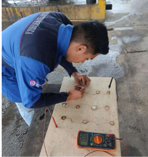
Figura 42. Armado y prueba de cubierta exterior de baldosa piezoeléctrica
