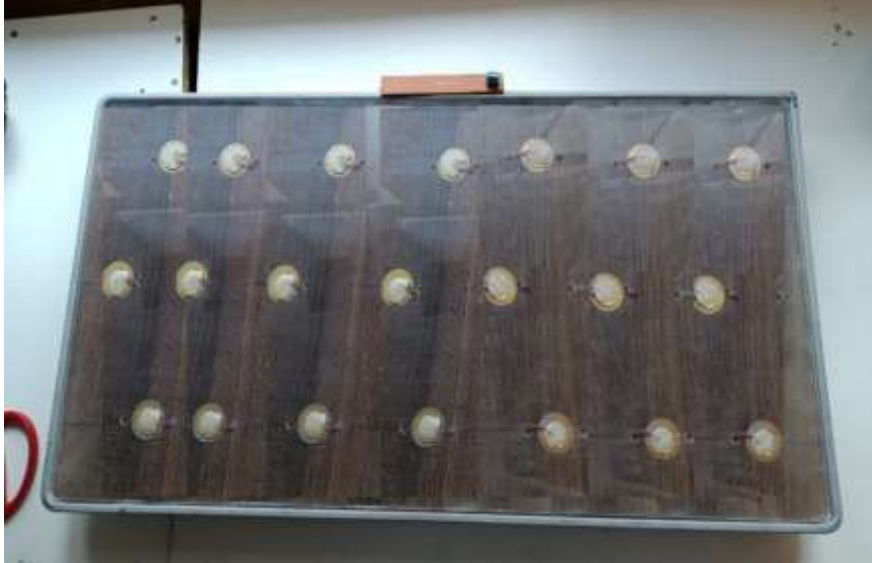
Figura 45. Baldosa piezoeléctrica y transductores implementados
