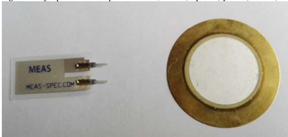
Figura 10. Ejemplo de sensores piezoeléctricos, PVDF (Izquierda) y PZT (Derecha).
