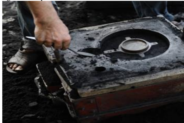
Figura 19. Operación de Moldeo
