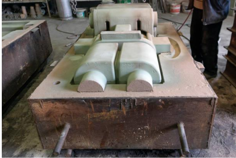
Figura 24. Proceso de desmolde manual.
