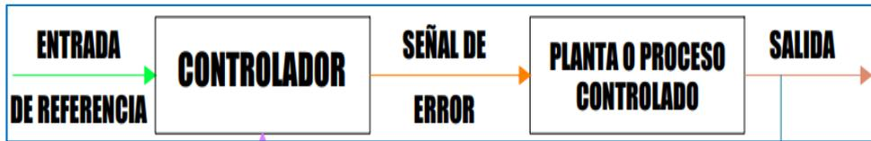
Figura 12. Sistema de Control de Lazo Abierto [14]
